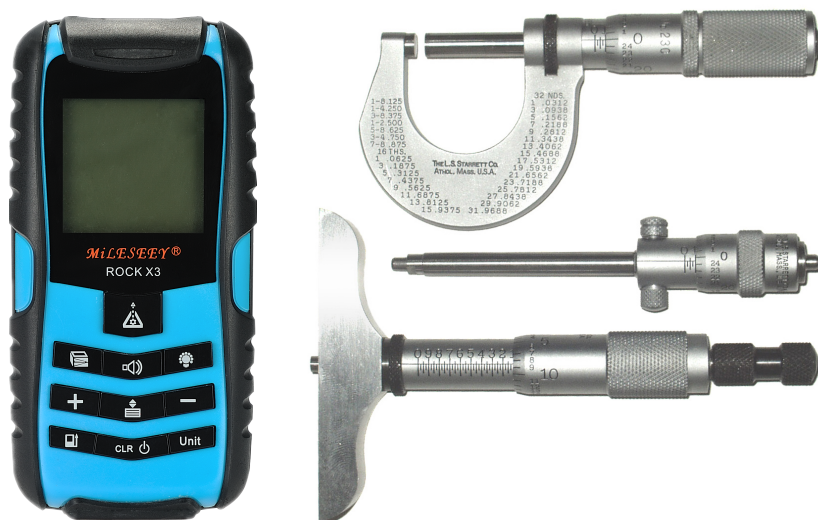
4.6. ábra. A pontos hosszmerés eszközei: Balra: lézeres távolságmérő. Jobbra: mérőcsavarok, külső, belső és mélységi mikrométer
