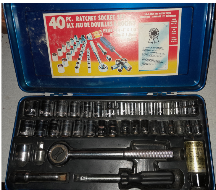
2.1. ábra. Kanadai dugókulcs-készlet metrikus (felső sor) és amerikai (alatta) méretben. A metrikus milliméterenként, az amerikai itt 1/16 inchenként változik, de létezik 9/32 inces méret is
