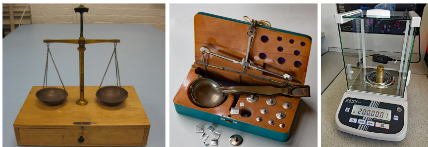
1.15. ábra. Balra: klasszikus egyensúlyi mérleg. Középen: ékszerésmérleg a súlyokkal. Jobbra: modern elektronikus kémiai mérleg
